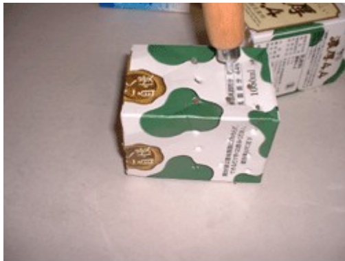
N02 四方の側面にも千枚通しで穴をあける 一面で（3+2+3）の8ヶ程度 計32ヶ
